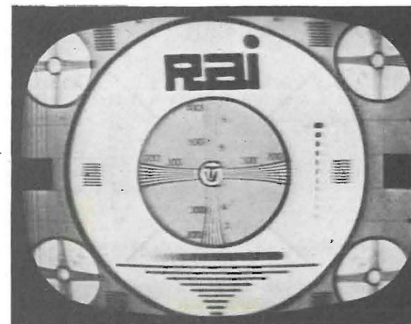
Fig. 6. — Code nere denotanti la presenza di distorsione alle basse frequenze.
